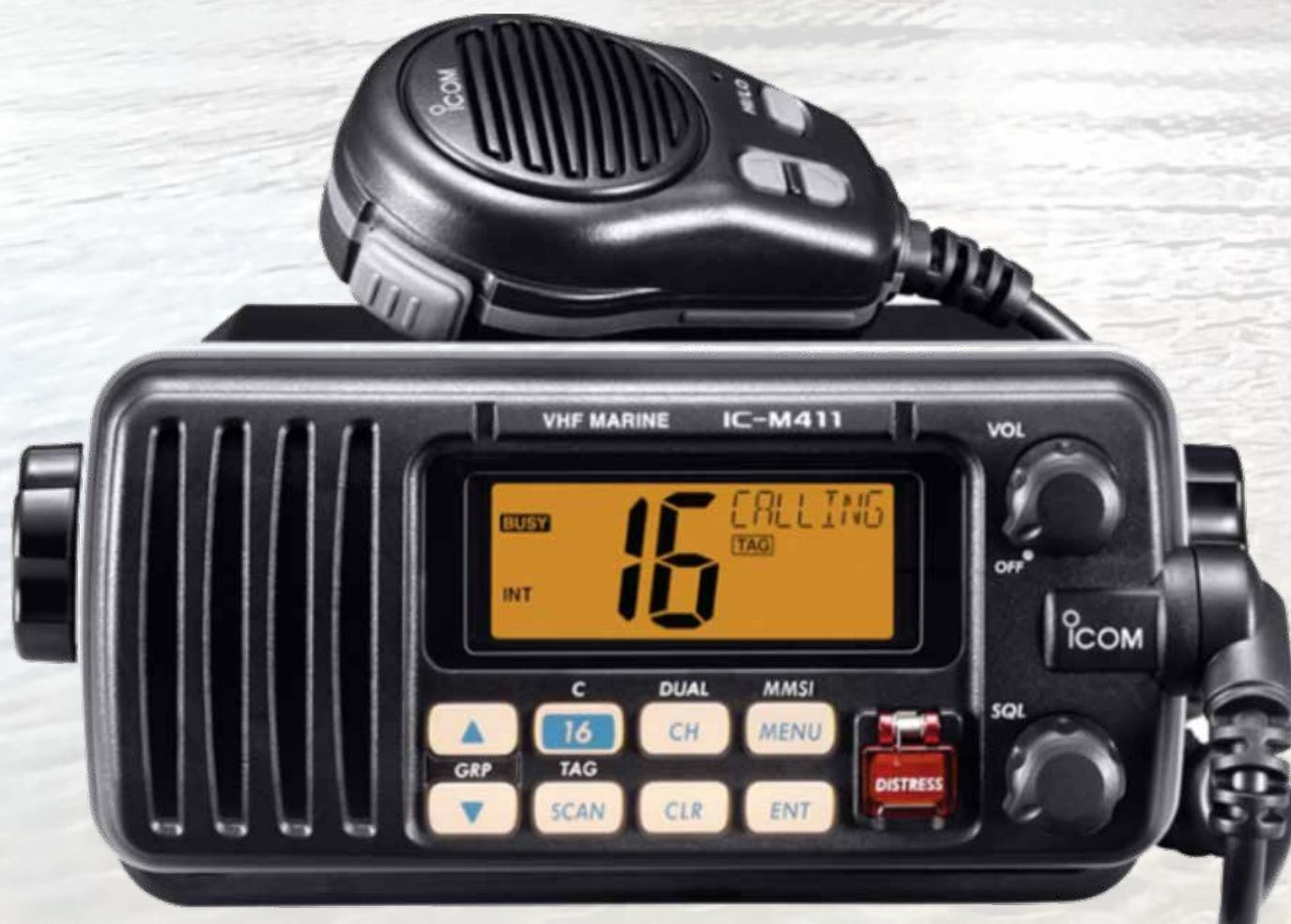
Los barcos que si estén equipados con emisora con LSD, tras sintonizar el canal 70, con pulsar durante al menos 5 segundos el botón DISTRESS (color rojo), en la propia pantalla aparece el mensaje completo previamente introducido y la alerta se enviará emitiendo digitalmente una señal de socorro acompañada de una señal sonora, que reciben las estaciones
